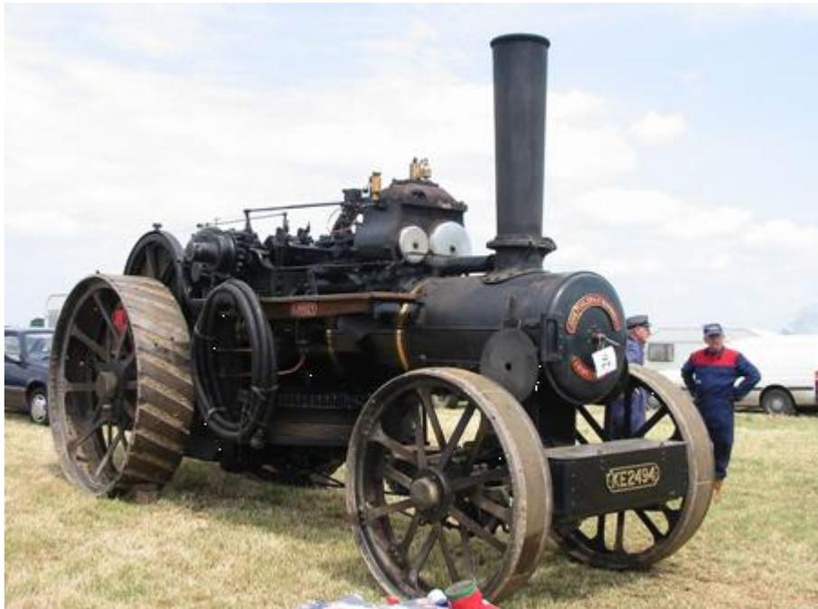
Les tractions engines devinrent des steam tractors, engins « véloce » à 3 vitesses routières, animés par un vaillant moteur compound. Ils furent beaucoup utilisés sur les sites industriels pour le transfert rapide de charges.
