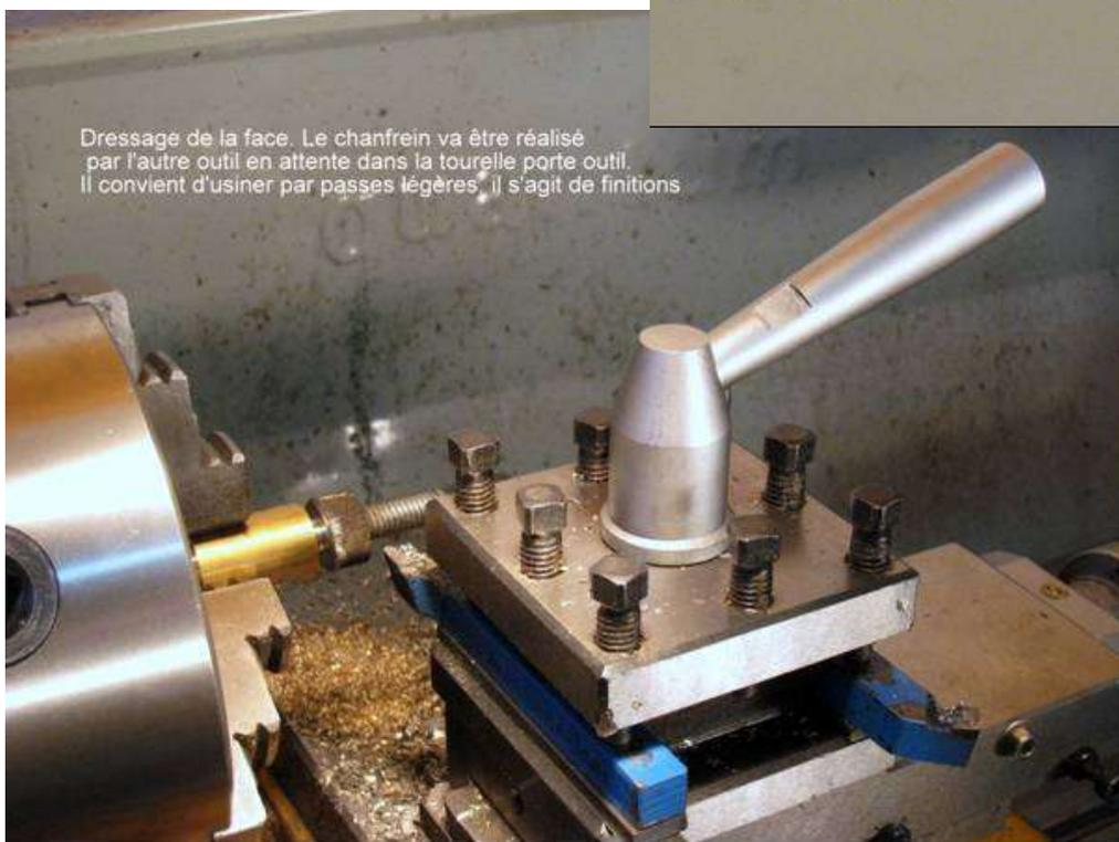
Dressage de la face. Le chanfrein va être réalisé par l'autre outil en attente dans la tourelle porte outil. Il convient d'usiner par passes légères, il s'agit de finitions
