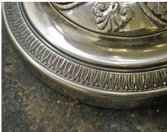
Le moletage est une opération d'usinage qui consiste à réaliser des stries pour augmenter l'adhérence d'une surface. En orfèvrerie cela concerne la réalisation d'un motif répétitif à l'aide d'un outil gravé qui repousse le métal.
