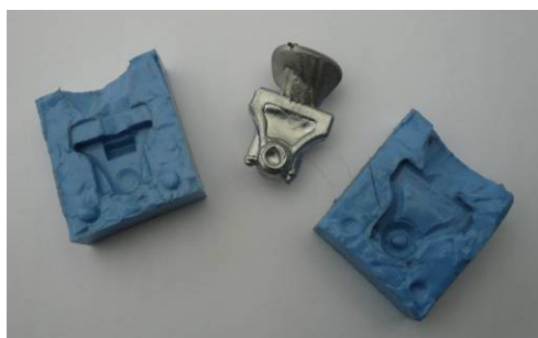
Démoulage de notre pièce
