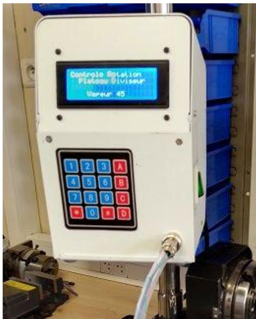
La carte Arduino est interfacée avec un clavier matriciel de 4x4 touches, et avec un écran LCD de 4 lignes de 20 caractères. Cet écran utilise une liaison série I2C, plutôt que parallèle, pour utiliser moins de broches.
