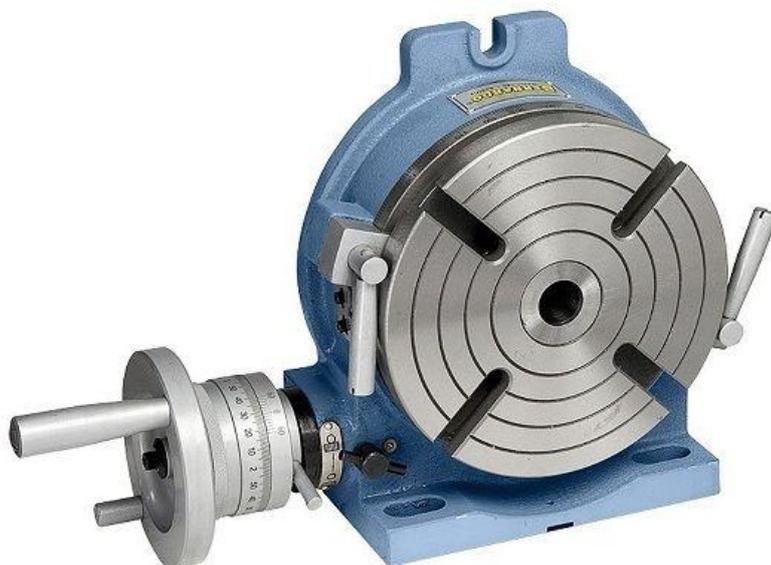
La rotation en est commandée par une vis sans fin, avec une graduation qui permet de mesurer les angles. Après un centrage correct par rapport à l'outil, on peut tracer des cercles, des arcs de cercles, ou diviser un cercle par une valeur choisie.
