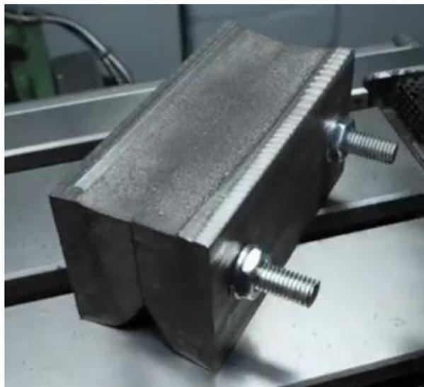
L'assemblage est repris en étau de fraisage. Surfaçage, puis défonçage des logements des mâchoires. L'usinage est réalisé aux cotes théoriques finales.
