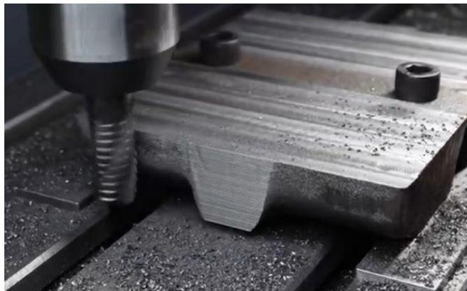
On perce les trous des vis M10 qui abloqueront les mors sur la table. On applique la même méthode que précédemment. La seule différence est que l'on fera une recherche d'arête sur les flancs pour respecter les cotes des plans.
