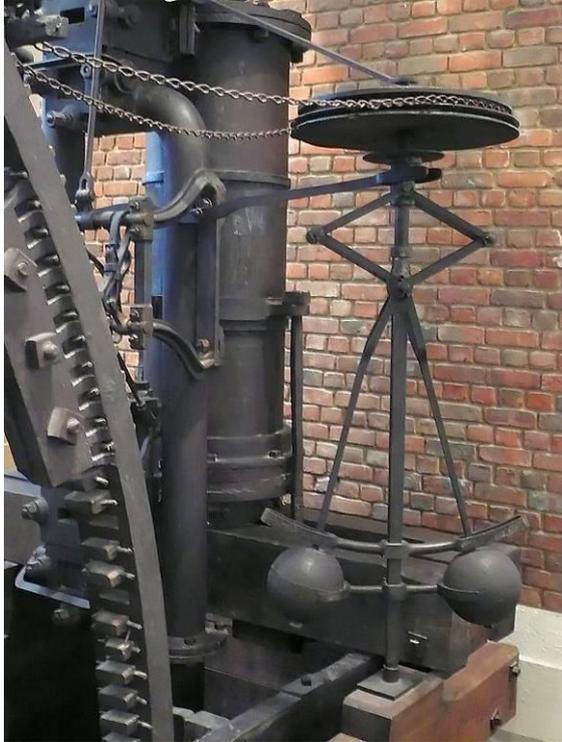
*Régulateur de Watt original sur machine à balancier (vers 1800).*
